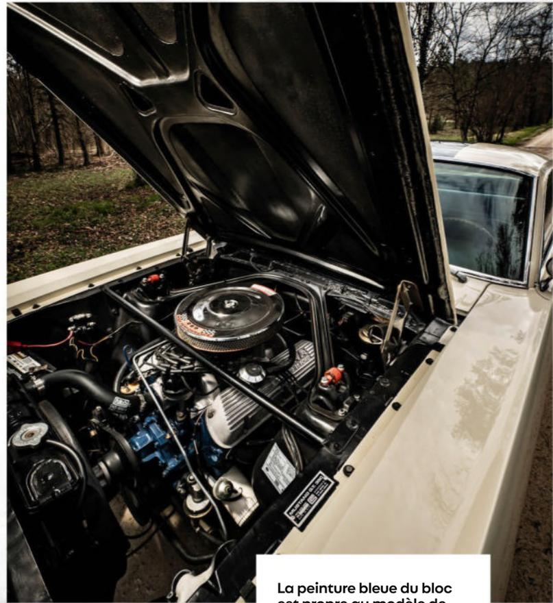
La peinture bleue du bloc est propre au modèle de 1966. Le V8, sans surprise, préfère les régimes intermédiaires mais comme on raffole des gargouillis qu'il émet dès le ralenti, le conducteur ne se sent pas lésé. Notre modèle, à la suspension perfectible, manquait parfois de rigueur en appui serré.
