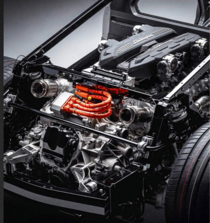
Le fait d'implanter la boîte transversalement libère de la place pour le diffuseur, au bénéfice de l'appui aérodynamique de la Revuelto.
