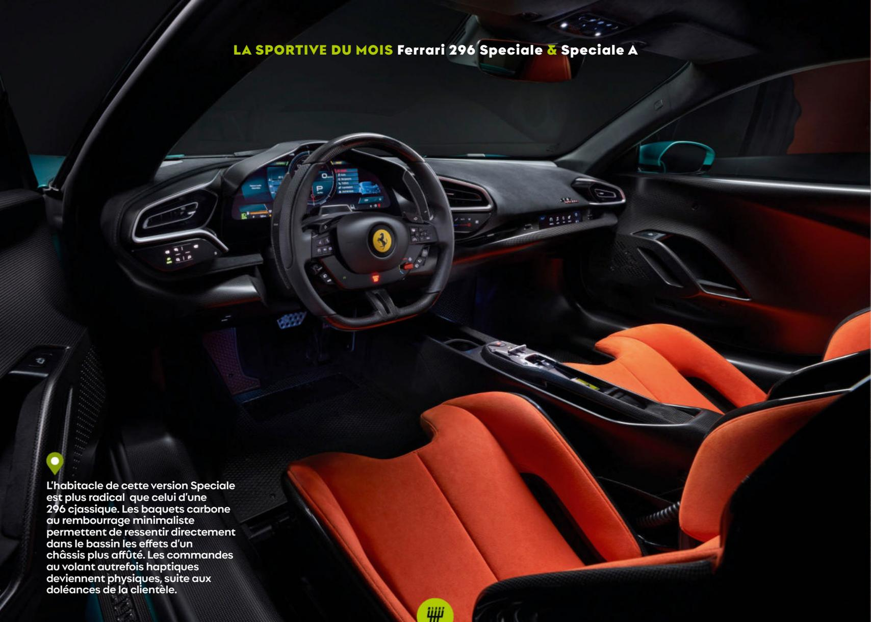
L'habitacle de cette version Speciale est plus radical que celui d'une 296 classique. Les baquets carbone au rembourrage minimaliste permettent de ressentir directement dans le bassin les effets d'un châssis plus affûté. Les commandes au volant autrefois haptiques deviennent physiques, suite aux doléances de la clientèle.
