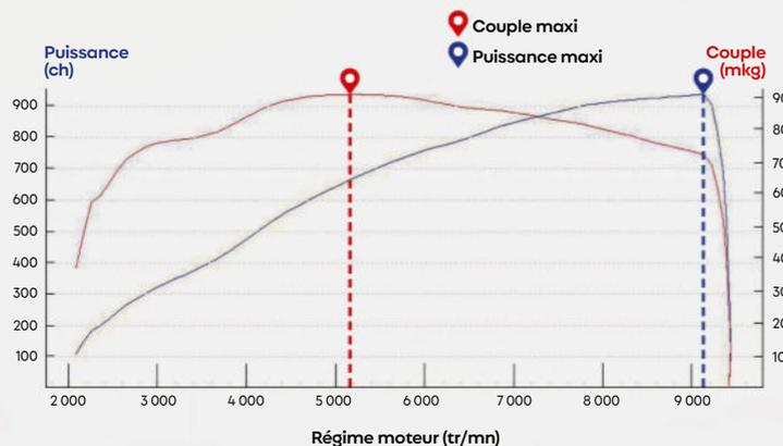
Mesures effectuées sur banc Superflow Windyn 2 ou 4 roues motrices, capable d'encaisser jusqu'à 1200 ch par essieu. Après le calcul des pertes de transmission, les mesures sont réalisées en freinant les rouleaux et en les accélérant. C'est donc la force nécessaire à leur ralentissement et à leur accélération qui détermine le couple puis la puissance maxi.
